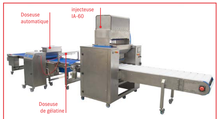
Ligne modulaire pour l'injection de croissants à la gélatine et garniture
