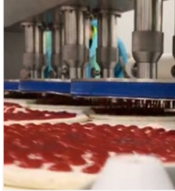
Boquillas con adaptador en forma de ducha para repartir la salsa de tomate en toda la base de la pizza.
