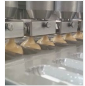
Boquillas con salida doble para repartir el producto en los moldes.
