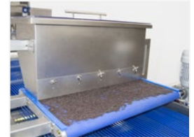
TPT - Topping automático de cinta, para virutas de chocolate, trozos de nueces, almendras, etc.
