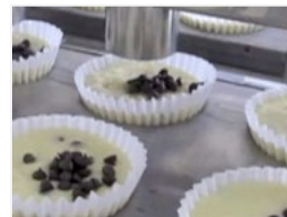
TPS - Doseur de topping pour graines, nappages moulus, copeaux de chocolat, noix de coco râpée.
