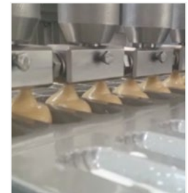
Doseur à double sortie pour répartir le produit dans les moules.
