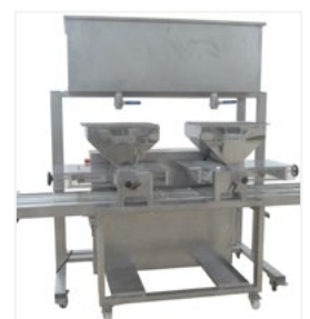
Double trémie pour le dosage de pâtes de deux couleurs ou de saveurs différentes.
