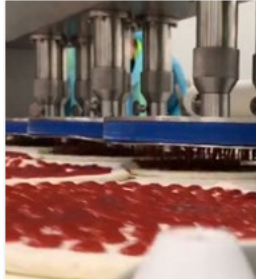
Embout avec sortie d'arrosage pour répandre de la sauce tomate dans le fond de la pizza.
