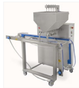
Modèle avec convoyeur rabattable pour optimiser le stockage.
