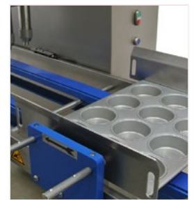
Convoyeur à courroie avec système pour placer des plateaux de différentes tailles.
