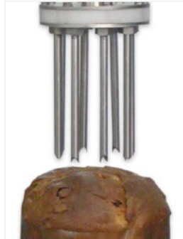
Grande douille d'injection circulaire pour remplir la panettone.
