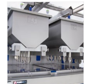
Trémie doublement chauffée pour travailler avec deux saveurs de garnitures.
