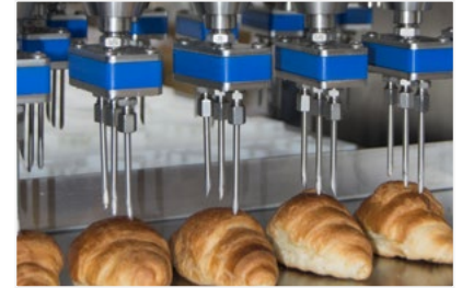
Douille à triple injection pour les garnitures de croissants.
